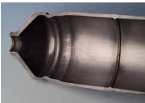
Plasma-Stichlochsweißung Durchschweißen in einer Lage
