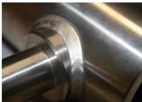
Roboterschweißung Edelstahlteil-Bauteil mit hohen optischen Anforderungen
