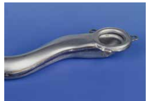
Schwierige 3-dimensionale Kontur Kehlnaht mit geringstem Platz für die Naht
