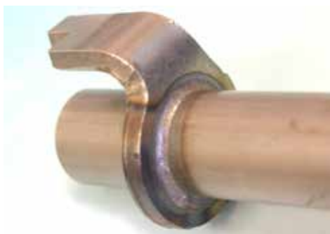
Laser-Pulverschweißung bei großen Spalten
