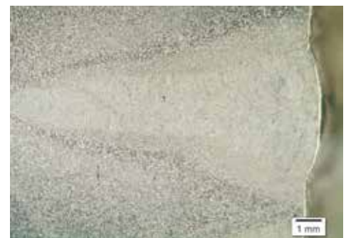
Schliffbild Laserschweißung schmale tiefe Naht
