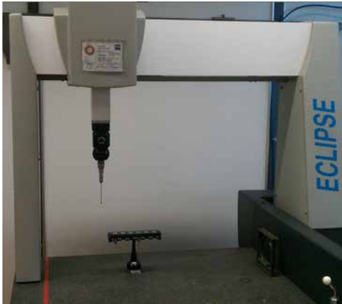
3-D-Messmaschine zur exakten Teilvermessung
