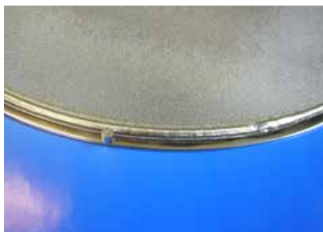
Plasmaschweißung 7 Filterbahnen an massive Metallplatte
