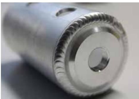
Dichtschweißung an Aluminium-Behälter
