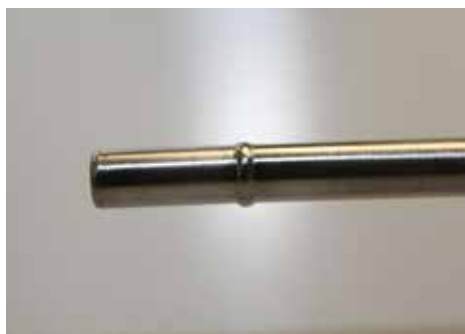
Laser-Auftragsschweißung RohrØ 6mm, Wandstärke: 0,4mm
