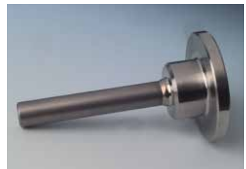
Hochkohlenstoffhaltiger Werkstoff an Nickel Basis-Werkstoff, extrem rissanfällig!
