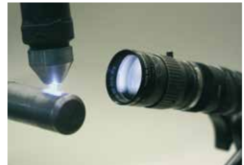
Überwachung der Schweißung durch Videotechnik
