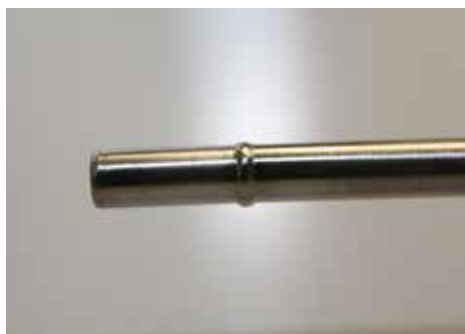
Laser-Auftragsschweißung RohrØ 6mm, Wandstärke: 0,4mm
