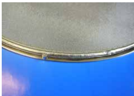
Plasmaschweißung 7 Filterbahnen an massive Metallplatte
