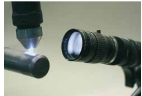
Überwachung der Schweißung durch Videotechnik
