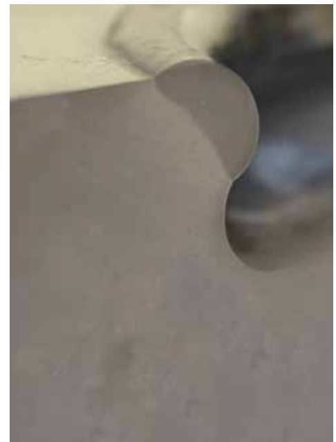
Schliff eines umgeschmolzenen Aluminium-Gussteils
