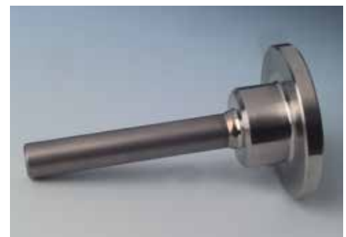
Hochkohlenstoffhaltiger Werkstoff an Nickel Basis-Werkstoff, extrem rissanfällig!
