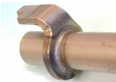
Laser-Pulverschweißung bei großen Spalten
