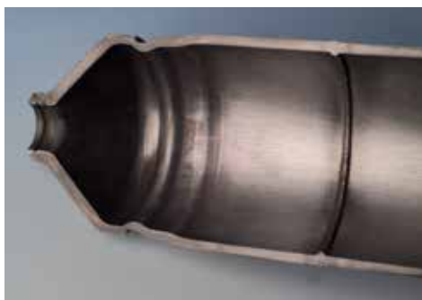
Plasma-Stichlochsweißung Durchschweißen in einer Lage
