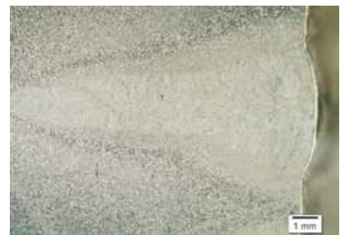
Schliffbild Laserschweißung schmale tiefe Naht
